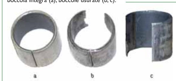
3. Fotografie di boccole di guida alloggiate nella testata anteriore: boccola integra (a); boccole usurate (b, c).
